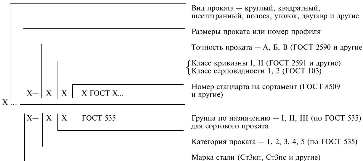
Прокат горячекатаный круглый диаметром 30 мм обычной точности прокатки (В), II класса кривизны, по ГОСТ 2590 марки Ст5сп, категории I, группы II:
