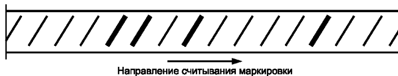
Рисунок 2 — Пример прокатной маркировки предприятия-изготовителя под номером 14
