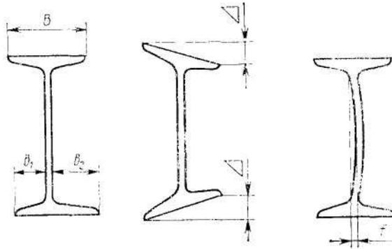
$b_1$ —ширина укороченного фланца;  $b_2$ —ширина удлиненного фланца;  $\Delta$ —перекос полки;  $f$ —прогиб стенки
